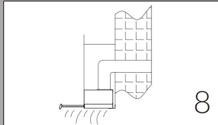
vertical es lo más común, si su cocina tiene un espacio en el ático por encima de los conductos, debe pasar a través del armario y el ático hasta una tapa del techo
