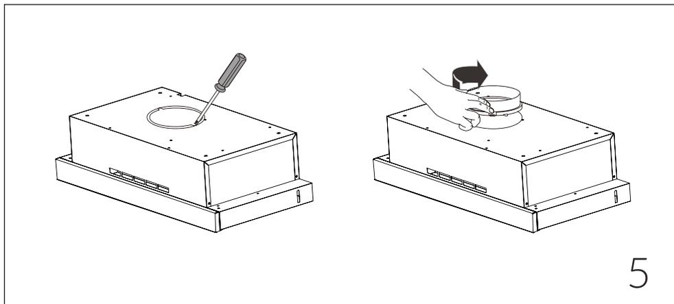
Antes de instalar su campana Smarthome, instale la tapa del amortiguador en la salida del ducto de la campana
