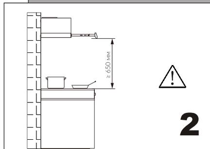
Se recomienda no instalar su campana extractora Smarhome a una distancia inferior de 650mm y superior de 750mm de los quemadores
